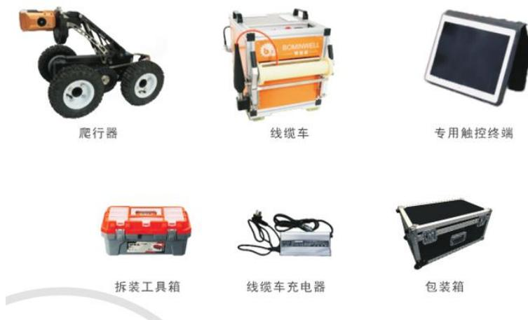
图 6.18 Dolphin-L2 管网检测机器人附件组成
