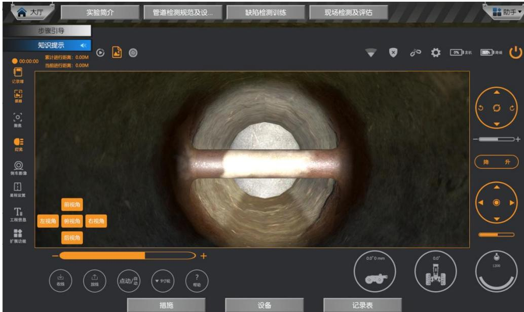
图 5-17a CCTV 地下管道摄像检测系统拍摄画面
