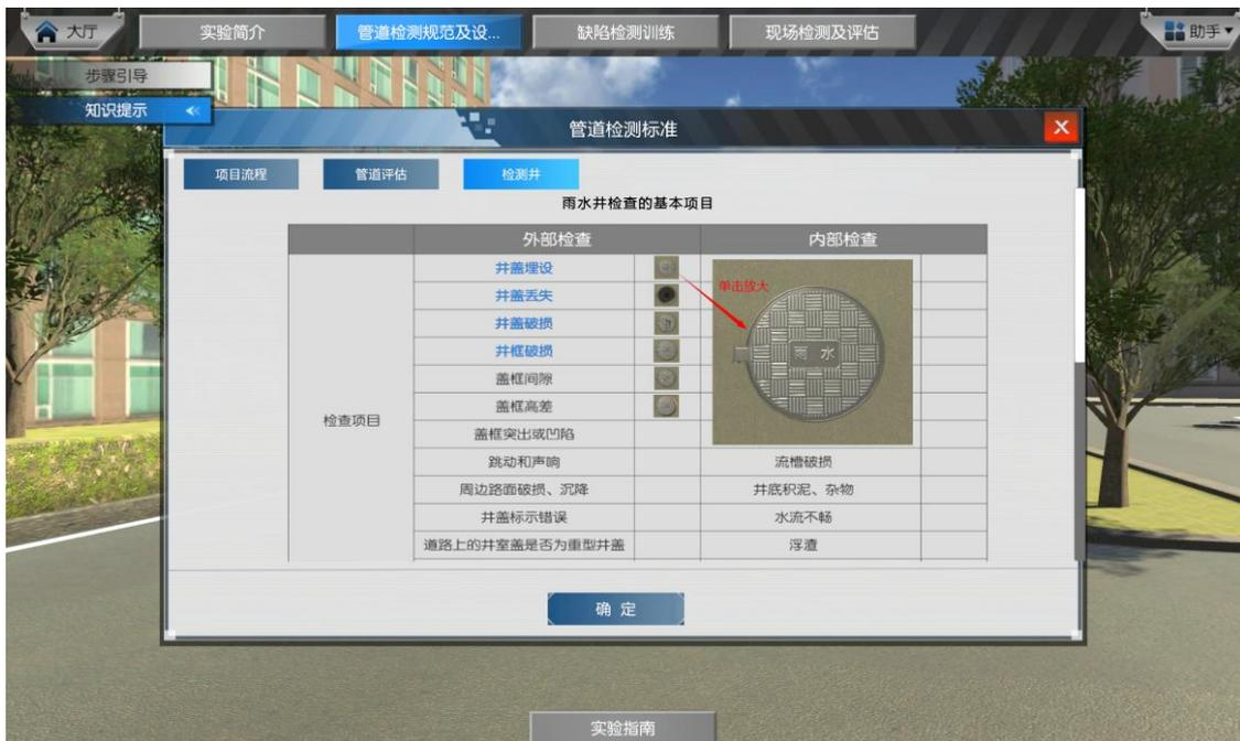
图 5-3 雨水井检查项目介绍
