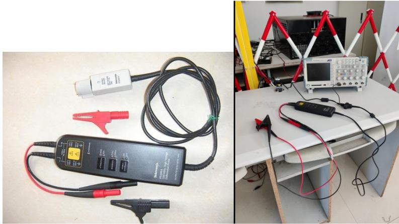
图 2-2 差分电压测量仪
